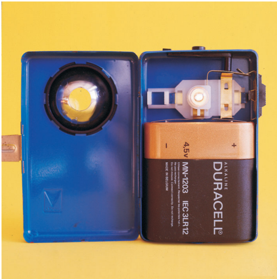
8.1 Taschenlampe als einfache elektrische Anlage
