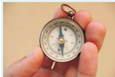
7.3. Kompass: Dreht man das Gehäuse so lange bis die Markierung „N“ mit dem Nordpol der Magnetnadel übereinstimmt, dann zeigt die Windrose die Himmelsrichtungen an.
