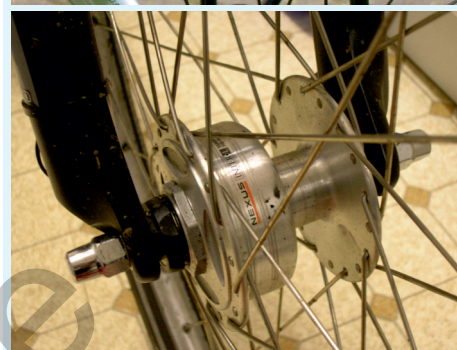
17.2. Ein Fahrraddynamo erzeugt den Strom für die Beleuchtung durch Induktion. (oben: Seitenläuferdynamo, unten: Nabendynamo)
