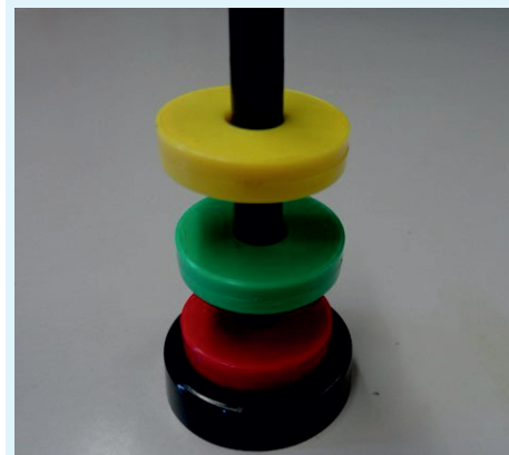
7.1. Schwebende Magnetringe zeigen die abstoßenden Kräfte zwischen den gleichnamigen Polen.
