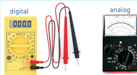
15.1. Digitales und analoges Vielfachmessgerät zur Strom- und Spannungsmessung
