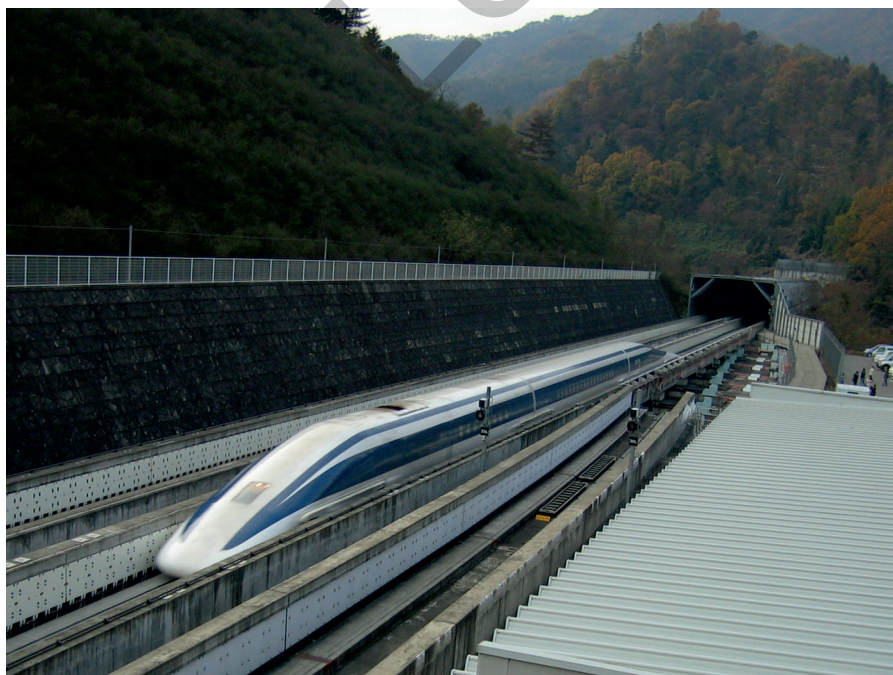
13.5. Auf einer Teststrecke erreichte der „JR-Maglev“ eine Höchstgeschwindigkeit von 603 km/h.
