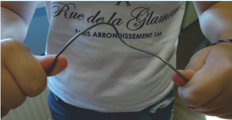
6.2. Der Draht wird an der Biegestelle ziemlich heiß.
