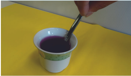
10.1. Auch der obere Teil des Löffels erwärmt sich rasch durch den heißen Tee. Die Wärme wird im Löffel nach oben geleitet.
