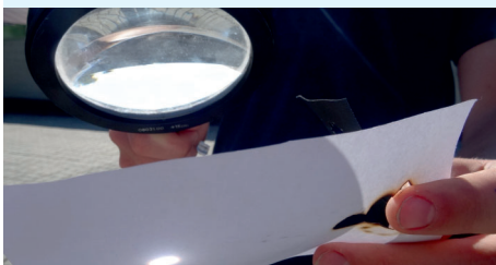
14.4. Wärmestrahlen können wie Lichtstrahlen mit „Sammellinsen“ gebündelt werden.
