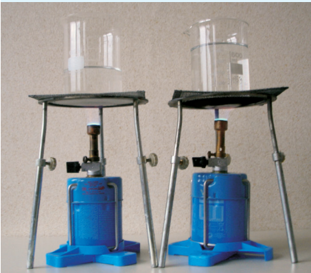
6.3. Je weniger Wasser, desto schneller erwärmt es sich bei gleicher Energiezufuhr. Je mehr Energie zugeführt wird, desto höher steigt die Temperatur.
