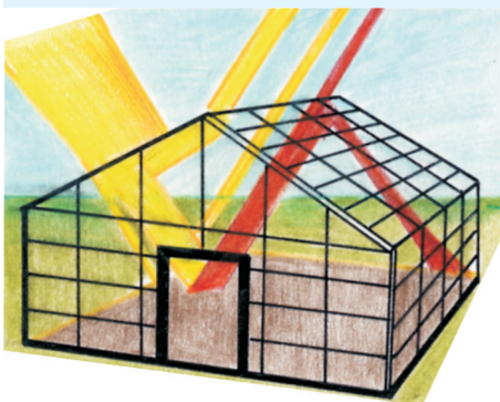
16.2. Auch bei einem Glashaus wird ein Teil der Wärmestrahlung nicht mehr hinausgelassen.
