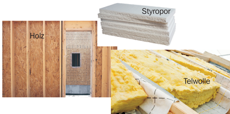
11.6. Verschiedene Wärmeisolatoren im Hausbau: Styropor, Telwolle, Holz
