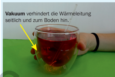
11.2. Doppelwandiges Trinkglas: Vakuum zwischen den zwei Wänden verhindert die Wärmeleitung. Du kannst dich nicht verbrennen.
