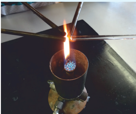
10.3. Verschiedene Stoffe leiten die Wärme unterschiedlich gut. Wer legt den Stab schneller aus der Hand? (V3)
