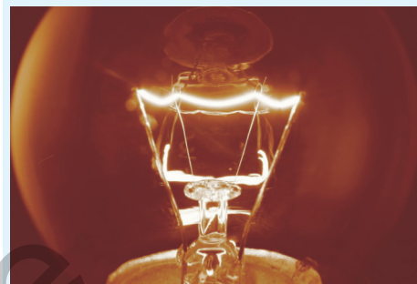
7.2. Eine eingeschaltete Glühlampe wandelt elektrische Energie in Licht und zu einem größeren Teil in Wärme um.
