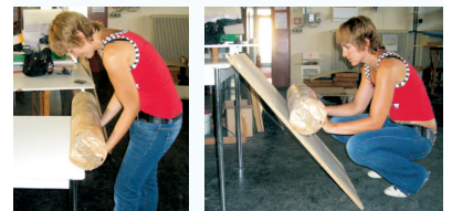
15.3. Die schiefe Ebene. Die Arbeit bleibt beim Hochheben und Hinaufrollen des Körpers die gleiche.
