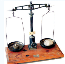
13.2. Balkenwaage → Grundsatz: „Körper mit gleicher Gewichtskraft haben gleiche Masse.“
