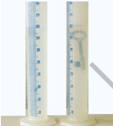
8.2. So kannst du das Volumen eines Körpers mit dem Messzylinder bestimmen.
