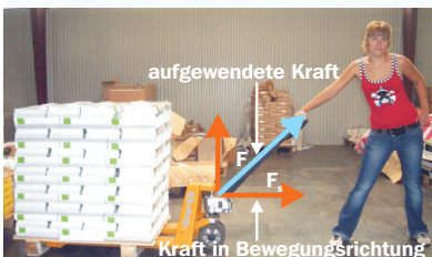
14.4. Für die Arbeit zählt nur der Teil der Kraft, der in Richtung des zurückgelegten Weges wirkt.
