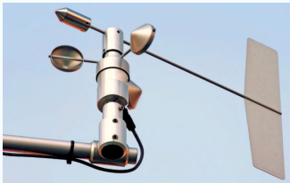
10.3. Mit Hilfe eines Anemometers kann man die Windgeschwindigkeit messen.
