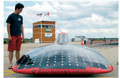
17.1. Ein Solarauto wandelt die Strahlungsenergie der Sonne in elektrische Energie und diese in Bewegungsenergie um.
