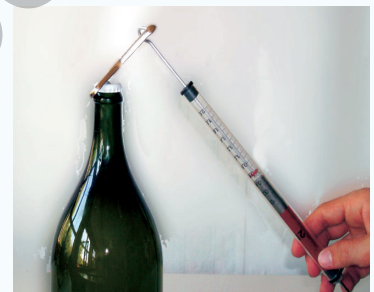
19.3. Ein Flaschenöffner als zweiseitiger Hebel. Wo sind hier die Angriffspunkte der Kräfte?
