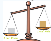
13.5. Körper mit gleichem Volumen, aber unterschiedlichen Massen
