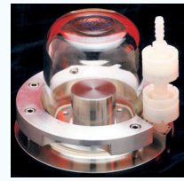
13.1. Urkilogramm: Zylindrischer Körper aus 90 % Platin und 10 % Iridium. Es wird in Sèvres in der Nähe von Paris aufbewahrt.
